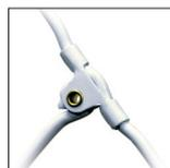
**10 stecche curve diametro 5** in acciaio zincato a caldo e rivestite con vernice a polvere epossidica di alta qualità, ricavate da un filo di acciaio armonico. La giunzione fra stecca corta e lunga avviene mediante un lamierino di ottone. Protezione della giunzione tramite ovale in tessuto *Sky*.
